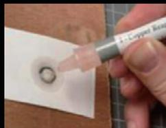
⑦ 試験紙を穴に約1分間強く押し当て、銅用の液体試薬を試験紙にかけます。
