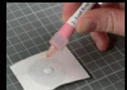
④ 鉛用の液体試薬を試験紙にかけます。
