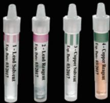
① 鉛、銅用の溶剤と液体試薬が密封されています。
