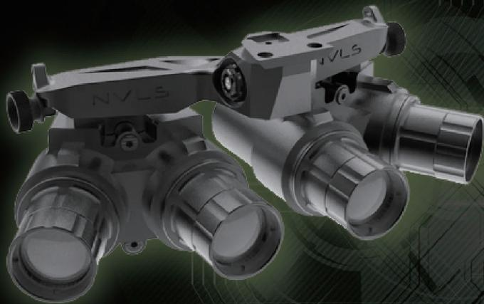
この軽量で超コンパクトで頑丈な（軽合金製ブリッジ）ナイトビジョン用パノラマゴーグルには、4本の超高性能Photonis 4Gイメージインテンシファイアチューブが搭載されており、ユーザーに104°の超広視野を提供します。この構成は、瞳孔間の調整が可能な2本の対になったチューブを前方に配置し、2本の側方のチューブが周辺視野を提供します。また、水深10M防水機能が搭載されています。
